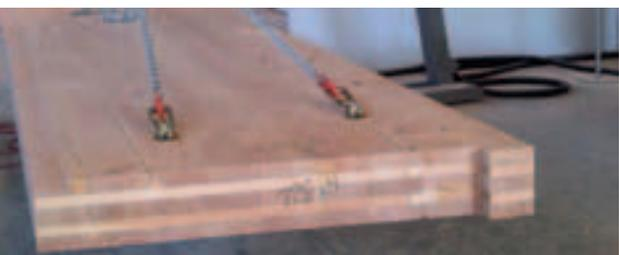
Incrociati (o compensato di tavole), ossia un pannello di legno massiccio formato dalla sovrapposizione e incollaggio di strati di tavole disposti ortogonalmente uno rispetto all'altro a formare elementi estremamente rigidi, resistenti e stabili dimensionalmente.
