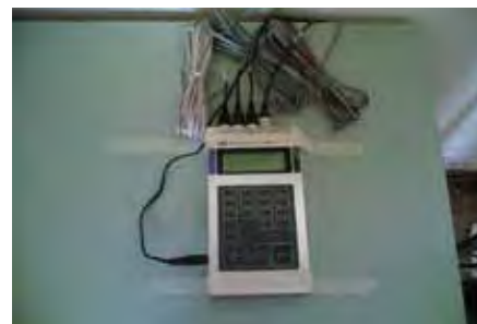
In alto: misura della conduttanza della parete
