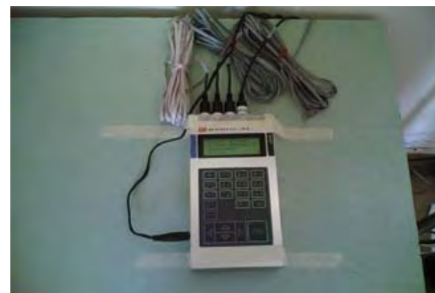
In alto: misura della conduttanza della parete Sotto: edificio analizzato con la tecnica della termografia a infrarossi
