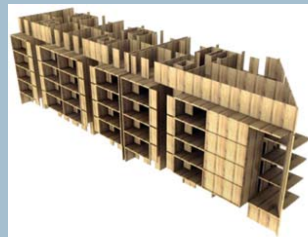
Figura 2: Schema delle strutture in pannelli di legno massiccio di un edificio di 6 piani in progetto a Firenze.
