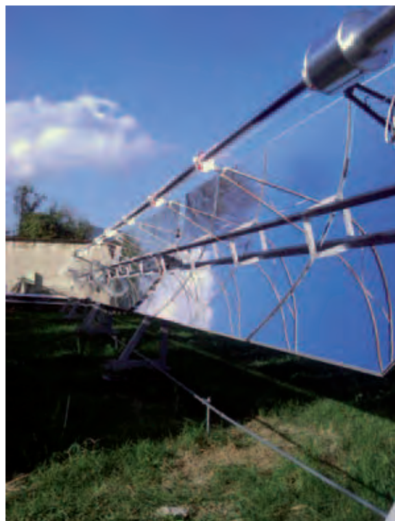
Due immagini di prototipi di dispositivi a concentrazione solare messi a punto dal Dipartimento di Ingegneria Industriale dell'Università degli Studi di Firenze
