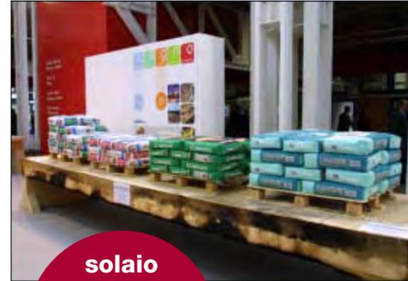
**solaio con luce=5,5 m carico 2 t dopo 60 min. di fuoco**
