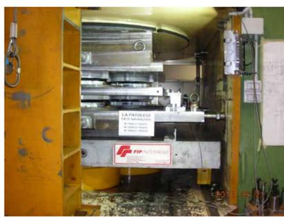
I dispositivi di isolamento, certificati con marcatura CE, durante le prove di accettazione in laboratorio
