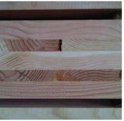
9. Le tavole vengono incollate a più strati incrociati e pressate per costituire, in spessore adeguato, le pareti e i solai della costruzione.
