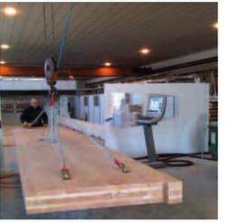
10. Sulla base del progetto da realizzare le tavole di compensato a strati incrociati vengono tagliate a misura con macchine a controllo numerico, per ottenere la massima precisione, che consentirà poi in cantiere di procedere al montaggio della struttura portante, pareti e solai, dell'edificio da realizzare.
