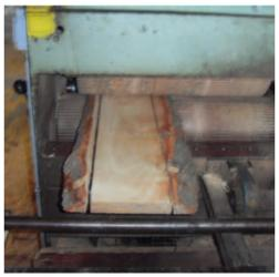
3. Tolleranza della corteccia, la segazione produce tavole che vengono poi rifilate a sezione rettangolare
