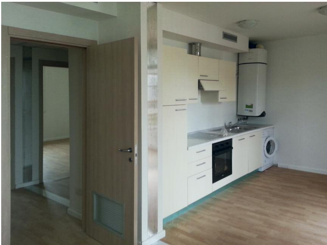
L'interno di uno degli alloggi con la cucina già predisposta in stabilimento.
