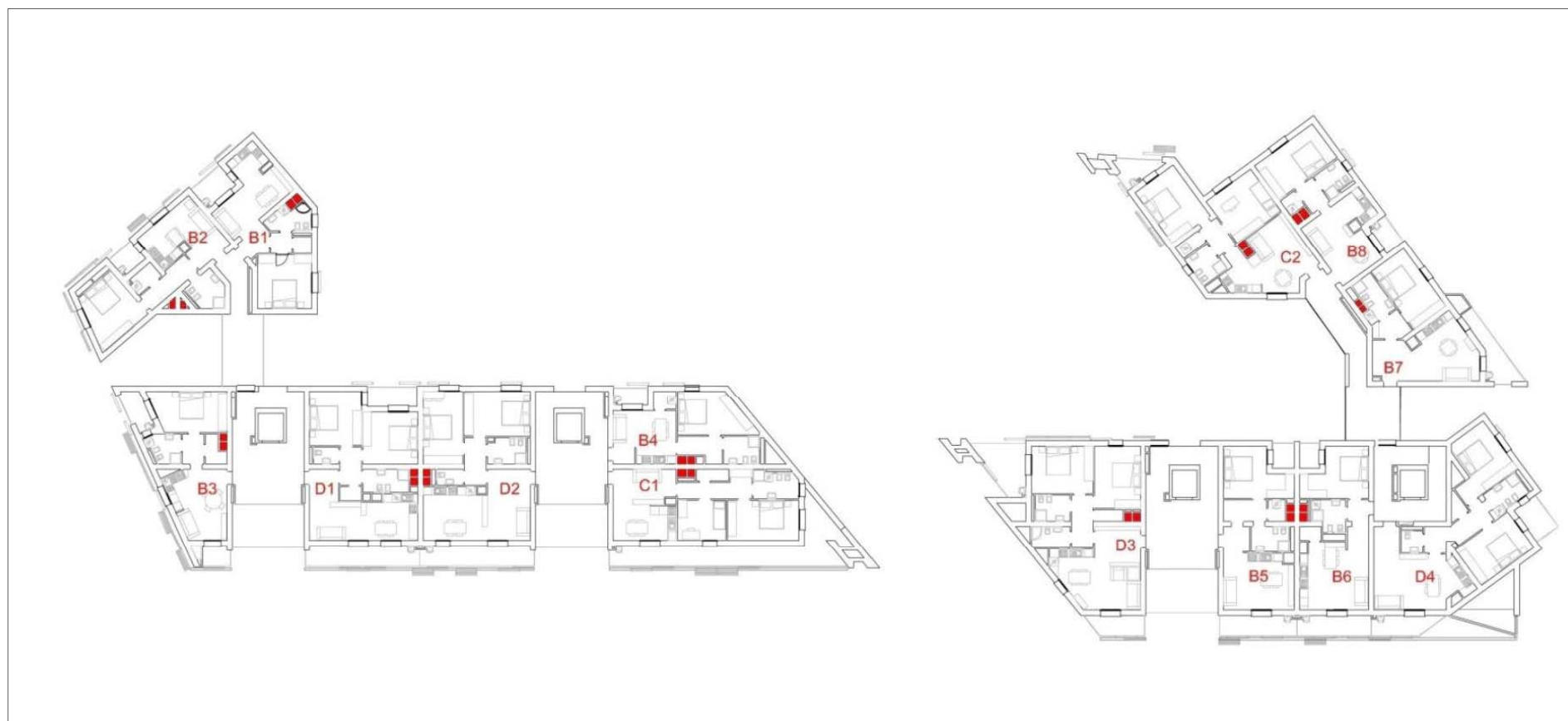
3. DISTRIBUZIONE VERTICALE DELL'ARIA NELLE TORRI DI VENTILAZIONE
